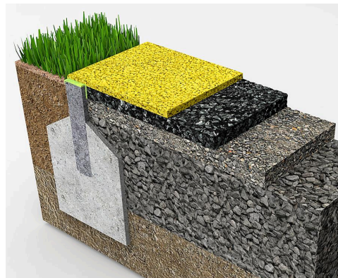
obr. zakončení pryže u obruby s jejím překrytím
